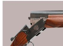
Уникальная конструкция шарнирного соединения затворной коробки и блока стволов позволяет разбирать/собирать ТОЗ-34 одним движением всего на две части
